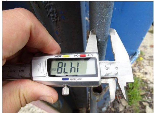
Rys. 71. Przykładowe pomiary grubości: a) urządzeniem ultradźwiękowym, b) suwmiarką
