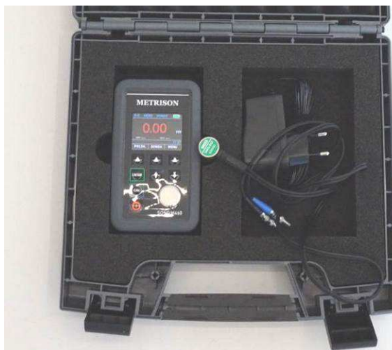
Rys. 25. Urządzenie SONO M460 z głowicą ultradźwiękową MEE5
