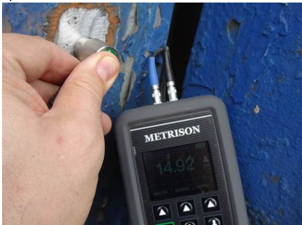
Rys. 71. Przykładowe pomiary grubości: a) urządzeniem ultradźwiękowym, b) suwmiarką
