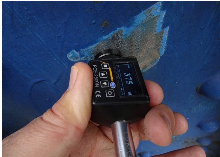
Rys. 70. Widok twardościomierza podczas badania na obiekcie
