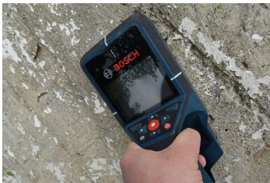
Rys. 6. Urządzenie Wallscanner D-TECT 200 C podczas badań
