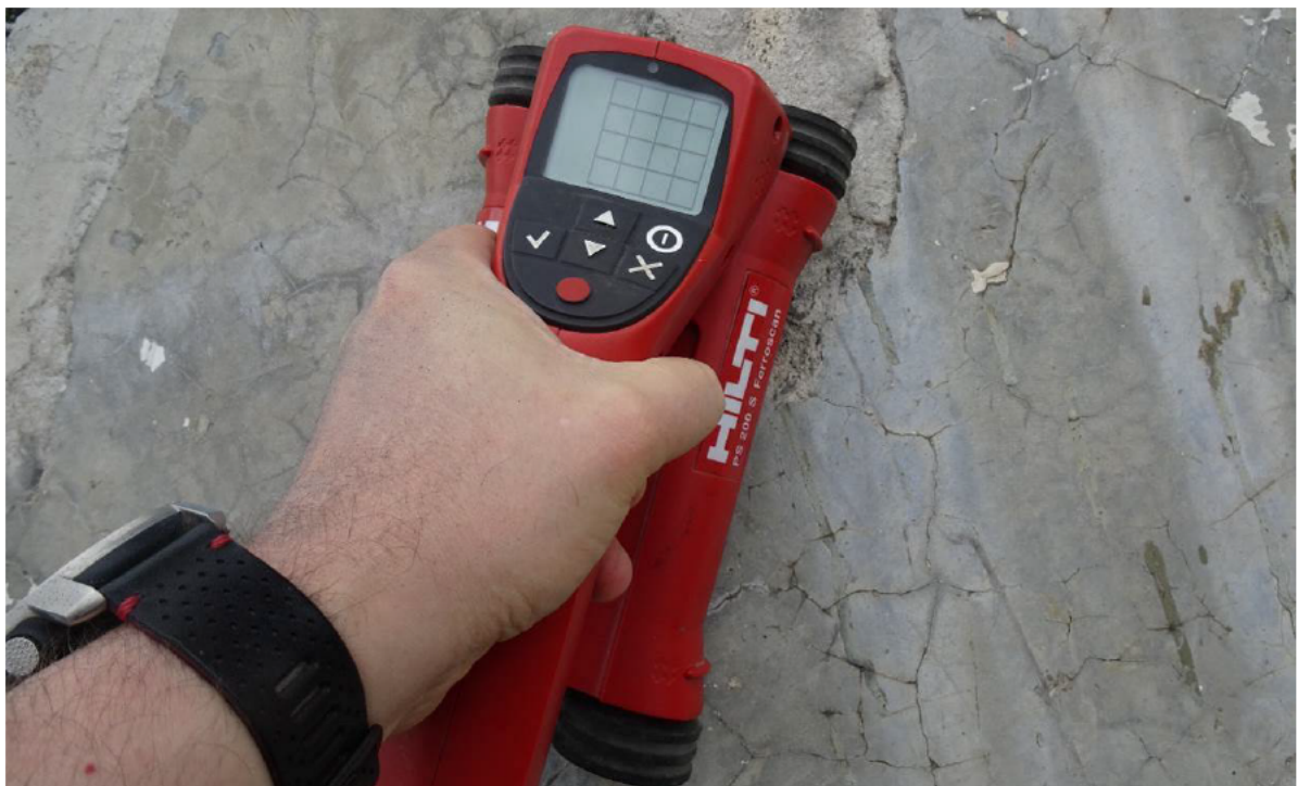
Rys. 3. Urządzenie Ferroskan Hilti PS 200S podczas badań
