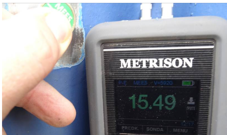
Rys. 28. Badanie w miejscu T3 – słup główny, kątownik – 15,49 mm
