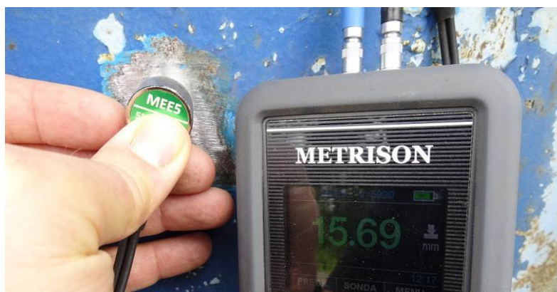
Rys. 27. Badanie w miejscu T2 – blachownica środkowa – 15,69 mm
