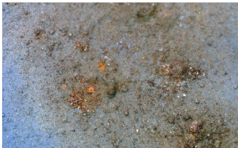
Rys. 42. Badanie mikroskopowe w miejscu widocznej korozji
