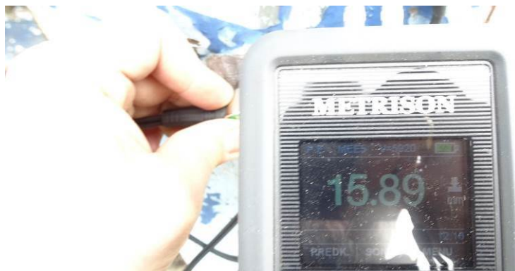
Rys. 26. Badanie w miejscu T1 – blachownica pas górny – 15,89 mm
