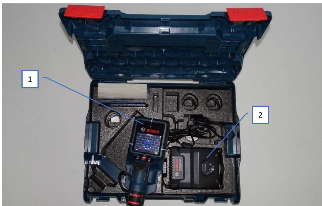
Rys. 4. Wallscanner D-TECT 200 C firmy BOSCH: 1- głowica skanująca, 2- ładowarka akumulatora
