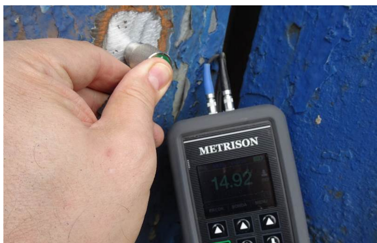
Rys. 30. Badanie w miejscu T6 – słup główny, kątownik – 14,92 mm
