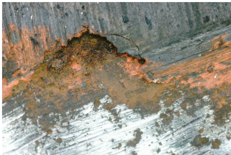
Rys. 38. Badanie mikroskopowe w miejscu T5. Widoczne warstwy farby i lokalna korozja
