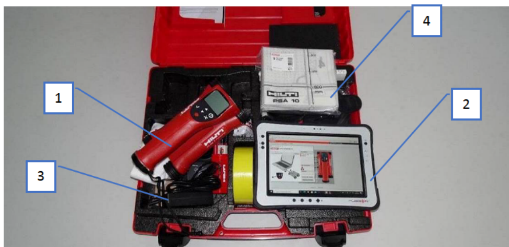
Rys. 1. Ferroskaner Hilti PS 200S: 1- głowica skanująca PS 200S, 2- tablet z portem IRDA służący do przechwytywania skanów, 3- ładowarka akumulatora, 4- papier zawierający przewodnice skanu
