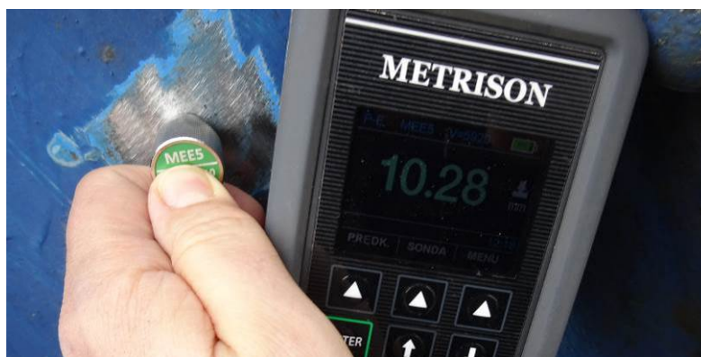
Rys. 29. Badanie w miejscu T4 – zastrzał, ceownik, średnik – 10,28 mm
