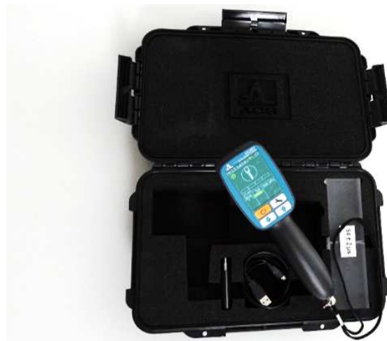
Rys. 16. Betonoskop UK1401 Surfer użyty w badaniach
