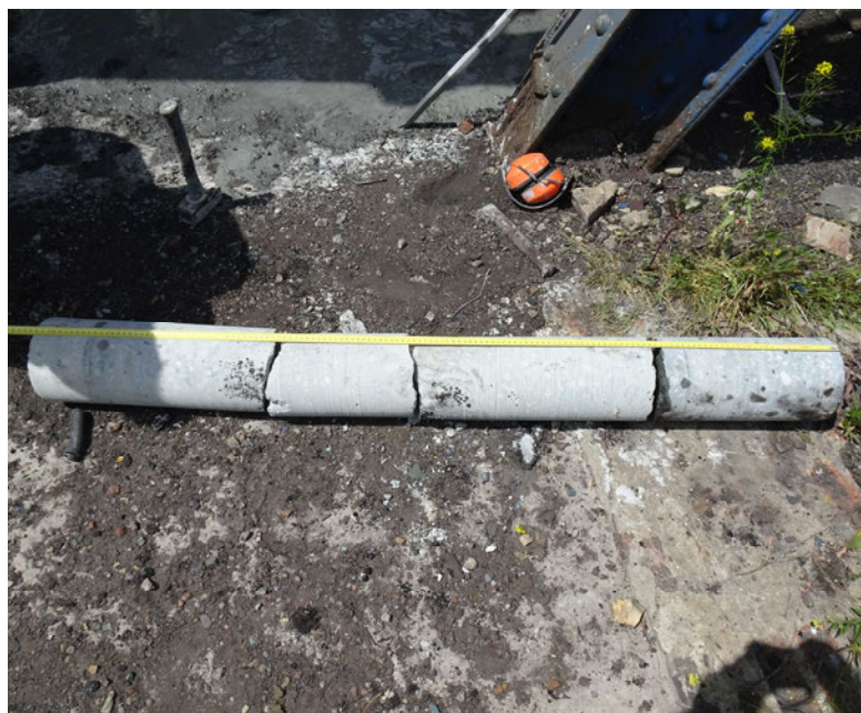
Rys. 73. Odwiercone rdzenie na głębokość 1,43 m
