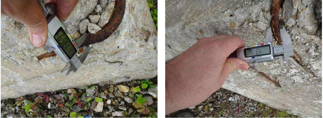
Rys. 15. Pomiar średnic zbrojenia
