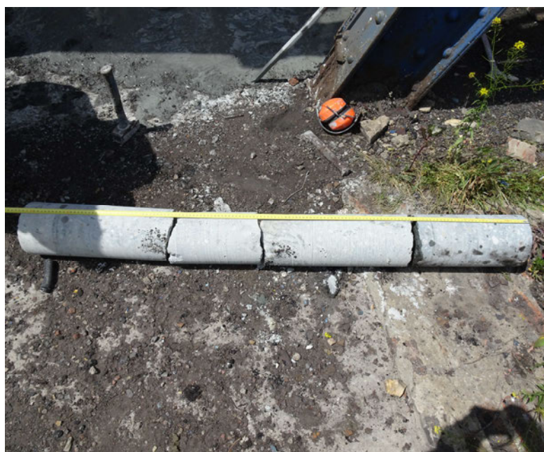
Rys. 45. Odwiercone rdzenie na głębokość 1,43 m
