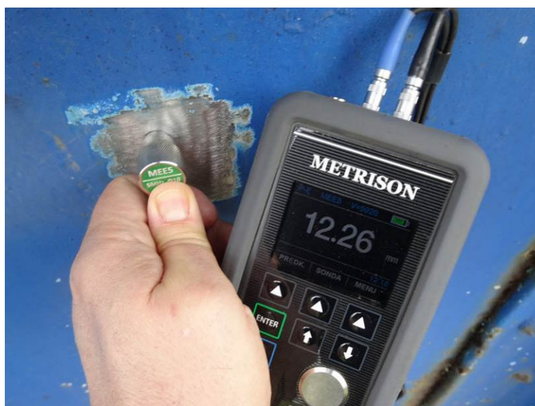
Rys. 31. Badanie w miejscu T7 – blachownica średnik – 12,26 mm
