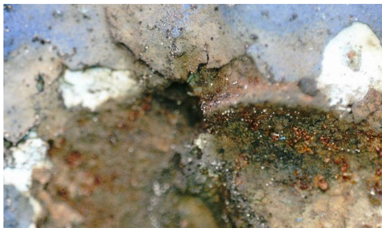
Rys. 43. Badanie mikroskopowe w miejscu widocznej korozji
